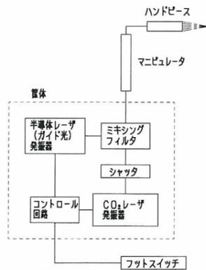
図2 作動・動作原理
